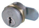
Hebelzylinder Nr. 5558/30 PSM Schlosskasten verlours verchromt Messing poliert vernickelt Schließbewegung 90° Schließweg nach Wahl Einbaumaß 25 mm
