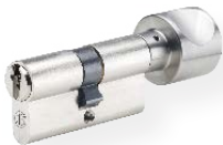
Knopprofielcilinder 815 PXM Messing mat vernikkeld Eén zijde met sleutel te bedienen, andere zijde aluminium knop, NF, diverse knopvormen verkrijgbaar (afgebeeld vorm H)
