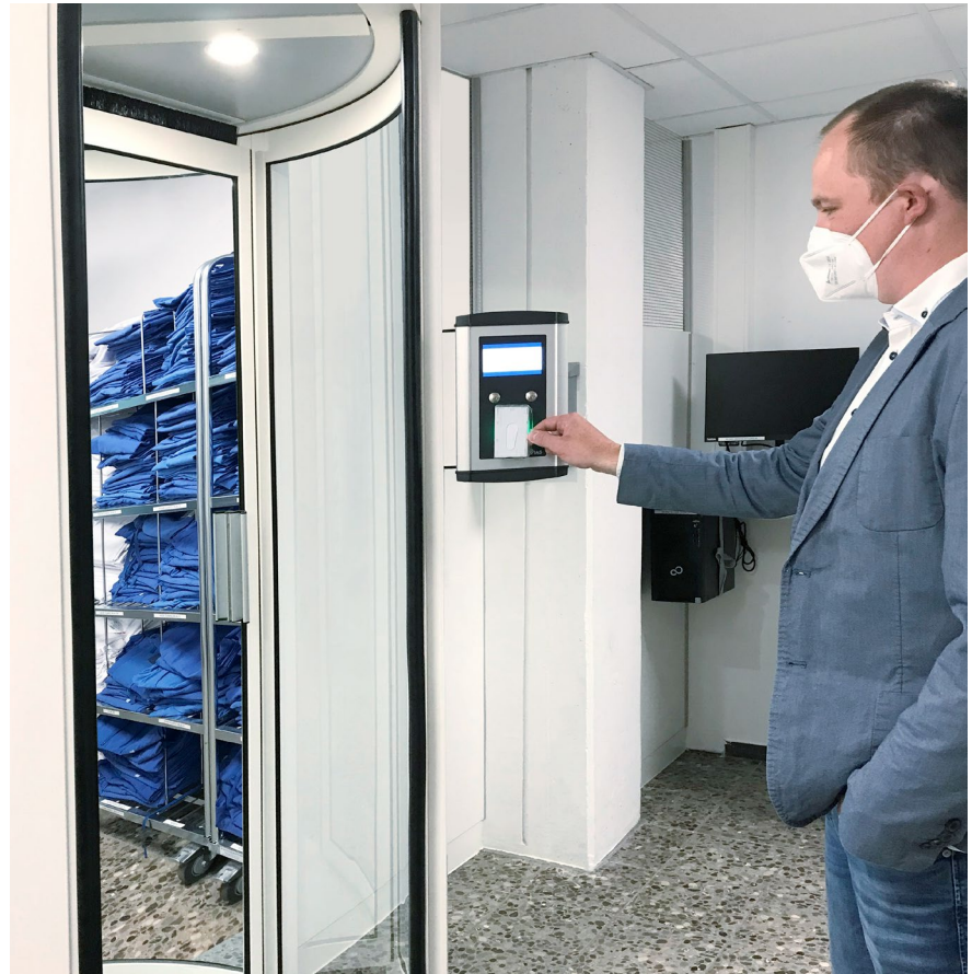
Über den Mitarbeiterausweis erfolgt die Authentifizierung für das KEMAS-Wäschesystem. Die Entnahme der Wäsche und die Rückgabe werden im KEMAS-System gebucht.
