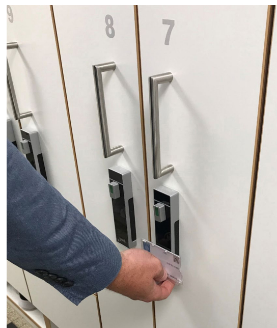
Die AccessOne-Software bietet verschiedene Einstellungen zur Nutzung der RFID-Möbelschlösser. In der Personalumkleide sind die Schlösser so programmiert, dass ein Mitarbeiter einen freien Schrank für 12 Stunden buchen kann.
