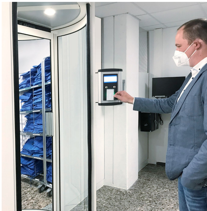
L'authentification pour le système de blanchisserie KEMAS se fait par le biais du badge de l'employé. Le retrait et le retour du linge sont comptabilisés dans le système KEMAS.
