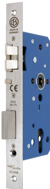
Abb. 2: Brandschutzschloss mit Panik-Wechselfunktion E mit Sperrfalle, zertifiziert nach den Normen DIN EN 12209 und EN 179
