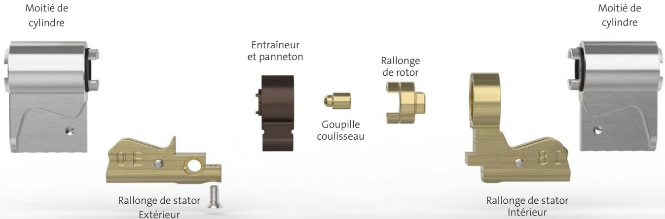
L'illustration montre un cylindre double 812MO + MOKI-08-00 avec des dimensions de 35,5 (intérieur)/27,5 mm (extérieur)
