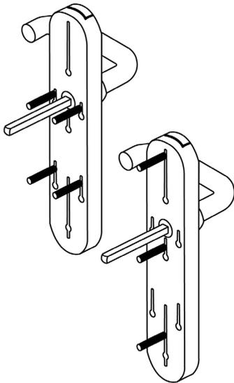
Der Innentürbeschlag ILS-I eignet sich zum Aus- und Umrüsten von bestehenden alten, mechanischen Beschlägen an Vollblatztüren (Türstärke 35–119 mm). Der Gegenbeschlag ist frei wählbar und nicht im Lieferumfang enthalten.
