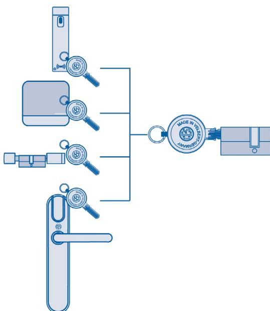
L'utilisation dans des systèmes de fermeture existants avec des appareils électroniques et des technologies de médias d'accès identiques est possible sans aucun problème. Ainsi, il est possible d'intégrer la clé électronique dans d'autres systèmes tels que des commandes d'ascenseurs, l'enregistrement du temps ou des systèmes de paiement. La clé électronique est disponible dans les coloris suivants :
