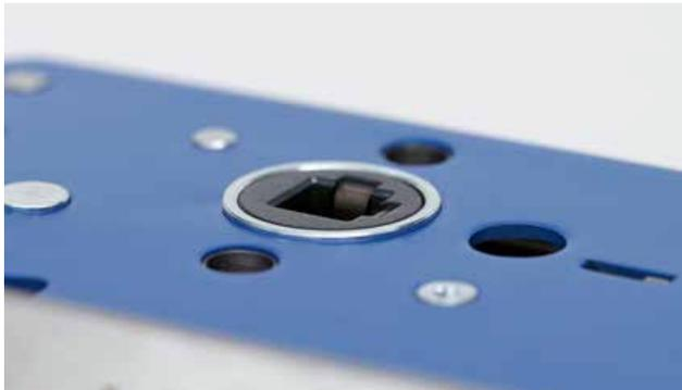
Die neue, von CES entwickelte in Stahlringen gelagerte TENAX-Klemmnuss ermöglicht eine einfache beidseitige Montage der Drücker-Vierkantstifte. Blattfedern im Inneren der Nuss sorgen für eine Fixierung und perfekten Sitz des Drückervierkants.
