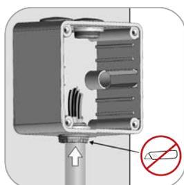
2. Führen Sie das Kabel durch die Rohreinführung des AUFPUTZ-RAHMENS.
