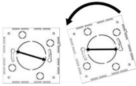
6. Halten Sie das Gehäuse schräg, so dass die großen Löcher auf der Rückseite eine waagerechte Linie ergeben.
