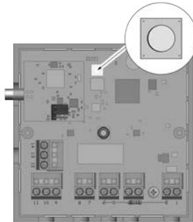
12. Koppeln Sie das Funkmodul-EMA mit den gewünschten Schließgeräten, bevor Sie das Gehäuse verschrauben (siehe "[Koppeln von Schließgeräten](#)" auf Seite 25).
