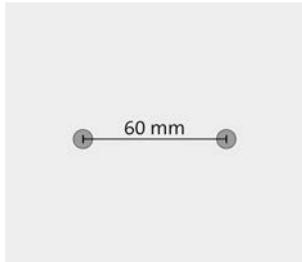
1. Bohren Sie die Löcher für die Befestigungsschrauben mit einem Abstand von 60 mm.
