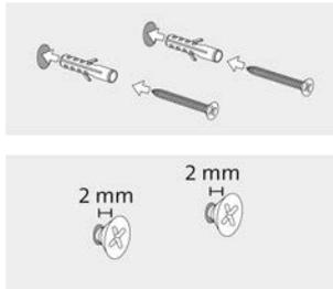
2. Setzen Sie die Dübel ein und schrauben Sie die Befestigungsschrauben ein. Lassen Sie dabei einen Abstand zwischen Schraubenkopf und Wand von ca. 2 mm.
