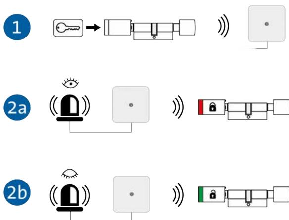
1. Der Elektronik-Zylinder liest ein berechtigtes Schließmedium. Daraufhin fragt der Elektronik-Zylinder beim Funkmodul-EMA den Status der EMA ab.
