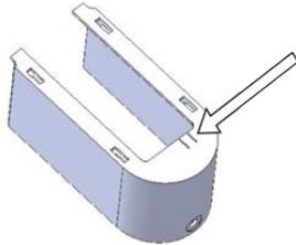
4. Brechen Sie aus dem Batteriefachdeckel die Ausbrechlasche ab.
