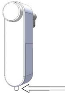
1. Lösen Sie die Design-Schraube von Hand.
