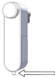
1. Lösen Sie die Design-Schraube.
