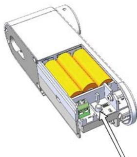
3. Drücken Sie die Kopplungstaste im Batteriefach des Motorzylinders ca. 1 Sekunde lang.
