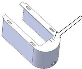
**5. Brechen Sie aus dem Batteriefachdeckel die Ausbrechlasche ab.**
