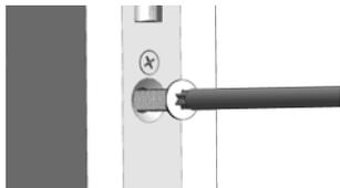
1. Lösen Sie die Stulpschraube des vorhandenen Zylinders.
