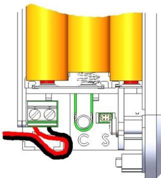
**6. Führen Sie das Stromkabel durch das Loch in den Motorzylinder (siehe Bild).**
