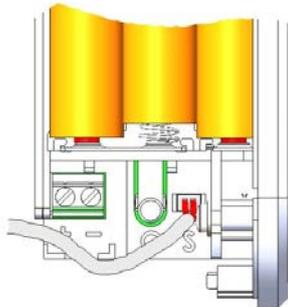
5. Führen Sie das Anschlusskabel durch die Öffnung in den Motorzylinder (siehe Bild).
