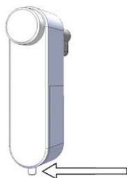
1. Lösen Sie die Design-Schraube von Hand.
