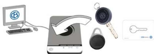
Connectez le Desktop-Writer par câble USB au PC ou à l'ordinateur portable équipé du logiciel d'installation.
