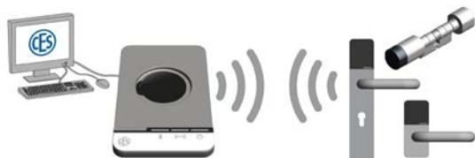
Connectez le Desktop-Writer par câble USB au PC ou à l'ordinateur portable équipé du logiciel d'installation.
