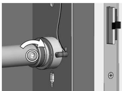
**3. Avvitare la VITE SENZA TESTA con la brugola nella MANIGLIA INTERNA per fissare il PERNO QUADRO.**
