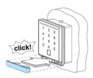
9. Schieben Sie die Verriegelungsleiste auf bis sie hörbar einrastet.
