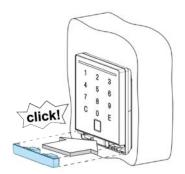
9. Schieben Sie die Verriegelungsleiste auf bis sie hörbar einrastet.
